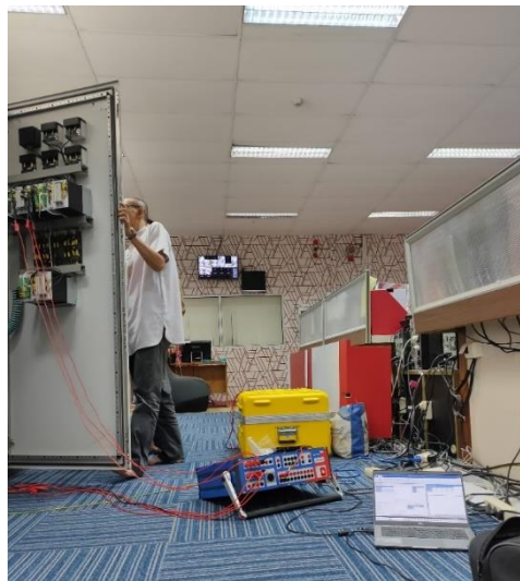
Gambar 4. 8 Proses Pengujian Relay Proteksi dengan Omicron CMC 356
