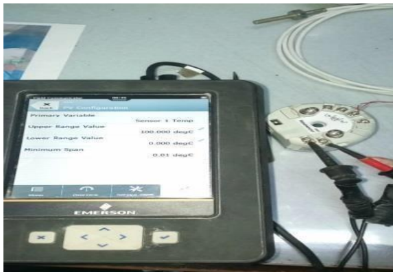
Gambar 3. 15 Mengubah range (sumber ; Dokumentasi di PT. Indah Kiat Pulp and Paper)
