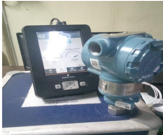
Gambar 3. 8 Pengaplikasian hart Communication pada transmitter (sumber ; Dokumentasi di PT. Indah Kiat Pulp and Paper)
