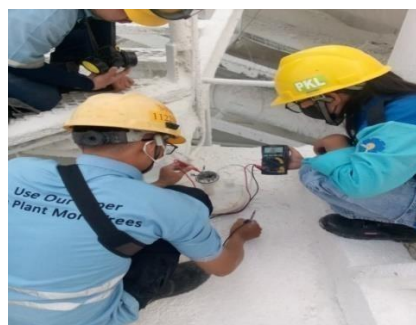
Gambar 2. 1 Mengukur sinyal output sensor RTD (Sumber : dokumentasi penulis, 2024)
