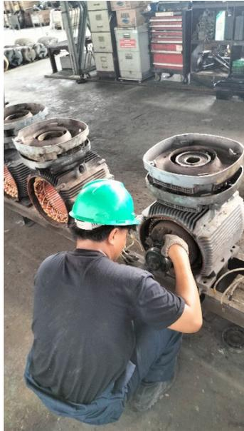
Gambar kegiatan 7. Penggantian *bearing* pada motor
