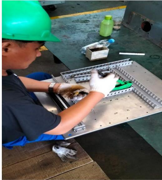
Gambar kegiatan 3. Pemasangan komponen panel ke *bar*
