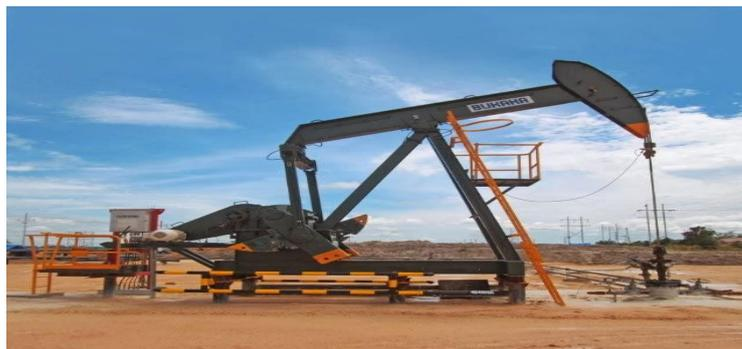
Gambar 3.1 Pompa Angguk (*Pumping Unit*)
