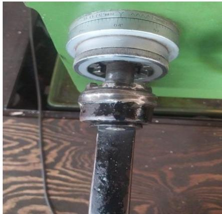
**Gambar 4.9 (a). *Handle* Penggerak Meja Vertikal**
