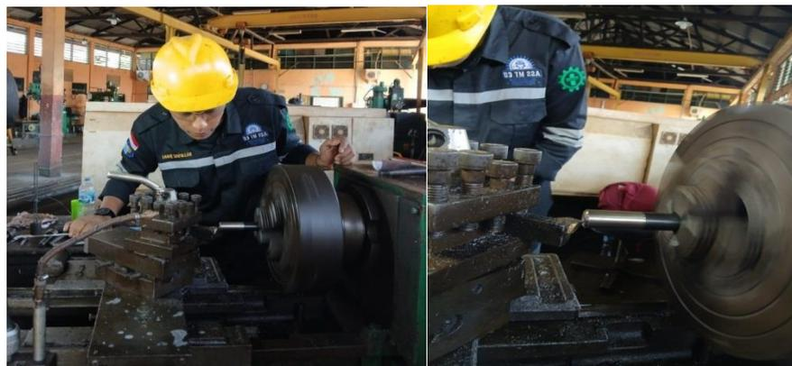
**Gambar 4.5 Proses Pembuatan *Chamfer***
