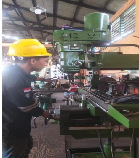
**Gambar 4.6 Proses *Setting* Benda Kerja Ke Mesin Frais**
