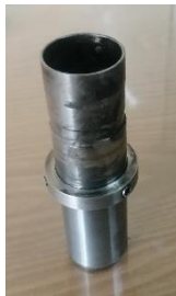
Gambar 4. 15 sahf sleeve sudah mengalami keausan hingga membentuk alur dan tidak layak digunakan (Sumber: Dokumen pribadi)
