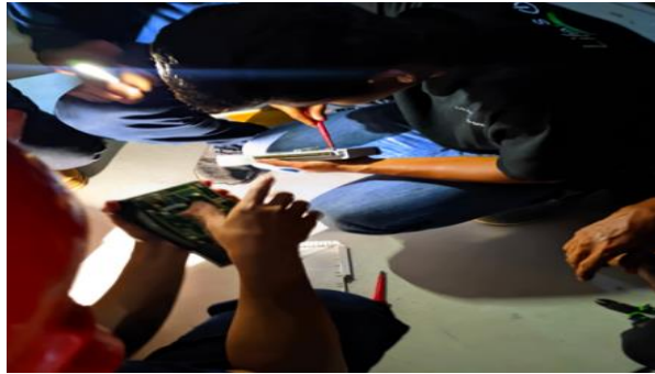
Gambar 2. 4 Perbaikan dan Penggantian module ABB VP01 (Sumber: Unit Layanan PLTA Koto Panjang. 2024)
