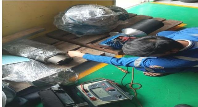
**Gambar 4. 14 Pengukuran tahanan isolasi**
