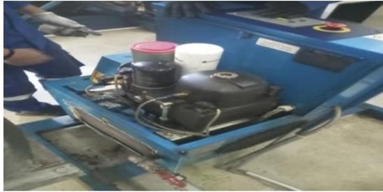
**Gambar 2. 29 Reaplace filter dan oli instrumen**
