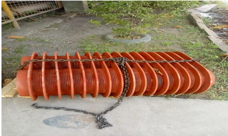
Gambar 5.2 press cage (pelat saringan minyak).
