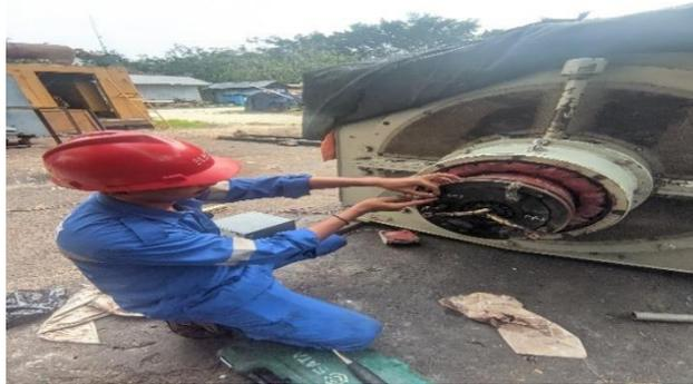
Gambar 2. 5 Bongkar rotating diode pada generator
