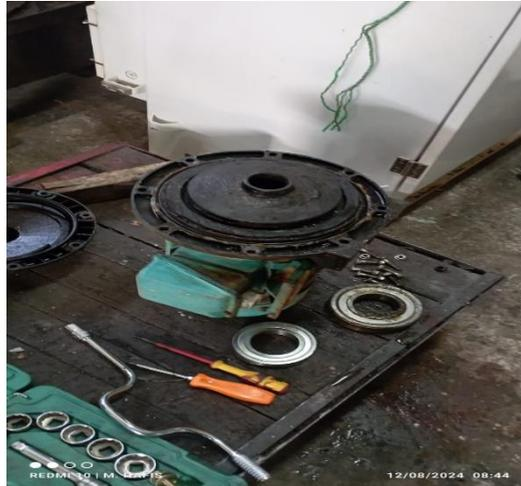
Gambar 2. 15 Ganti bering motor yang sudah noise
