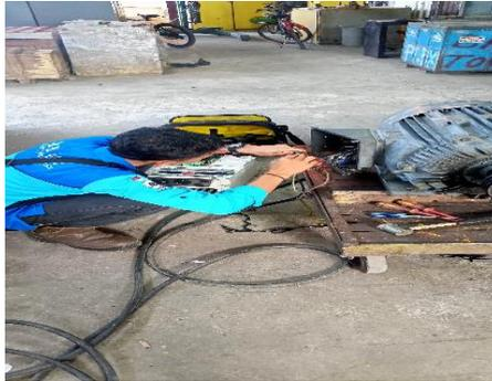
Gambar 2. 2 Melakukan pemasangan motor 3 fasa menggunakan ASD.
