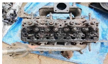
Gambar 4. 18 Proses Pembongkaran Kepala Silinder Sumber: Dokumen Pribadi
