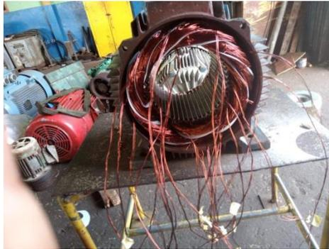
**Gambar 1. 2 motor 3 fasa untuk pendingin minyak nafta.**
