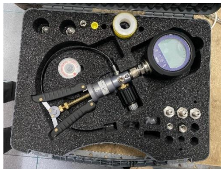
Gambar 2. 54 Pressurecalibrator Sumber : (Dokumentasi, 2024)
