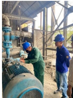
Gambar 2. 2 Proses Pengecekan Vibrasi Menggunakan Stetoskop Sumber : (Dokumentasi, 2024)
