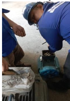
Gambar 2. 1 Proses Pengukuran Insulasi Winding Elektroelectromotor Menggunakan Alat Ukur Megger Tester
