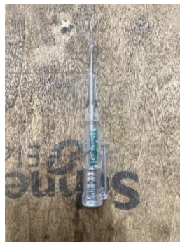
Gambar 2. 46 Test Pen Sumber : (Dokumentasi, 2024)
