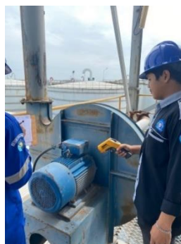
Gambar 2. 9 Pengukuran Suhu Pada Body Electromotor Menggunakan Thermo gun Sumber : (Dokumentasi, 2024)
