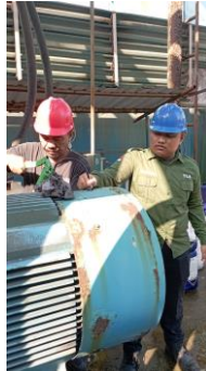
Gambar 2. 22 Pengisian Grease Pada Bearing Electromotor Sumber : (Dokumentasi, 2024)
