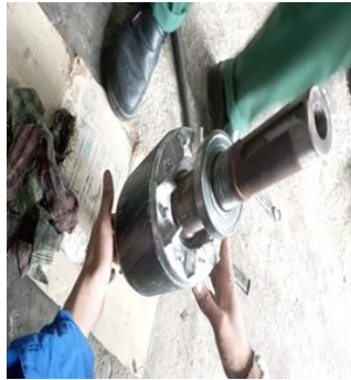
Gambar 2. 32 Pemasangan Bearing Baru Pada Rotor Sumber : (Dokumentasi, 2024)
