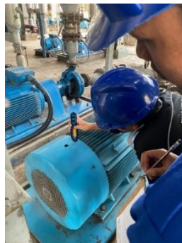
Gambar 2. 8 Pengukuran Vibrasi Pada Body Electromotor Sumber : (Dokumentasi, 2024)
