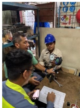
Gambar 2. 13 Verifikasi Pressure Gauge Menggunakan Pressure Calibrator Sumber : (Dokumentasi, 2024)
