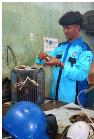
Gambar 2.11 Memasang Lilitan dan Mengcouple Elmot Sumber:PTPNIVSei Buatan
