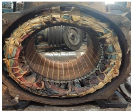
Gambar 3.8 : Kumparan stator yang terbakar (Sumber : Dokumentasi Penulis 2024)
