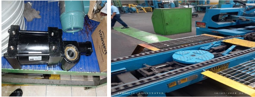
Gambar 3. 26 Gambar Cylinder rotary yang digunakan dan bentuk turn table yang ada di area baling lane
