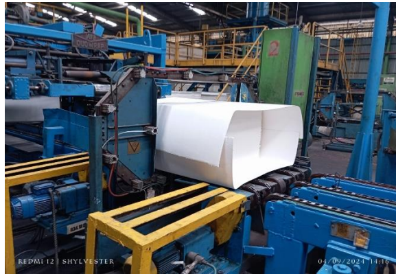
Gambar 3. 24 Gambar mesin Robotyer yang mengikat bale pulp
