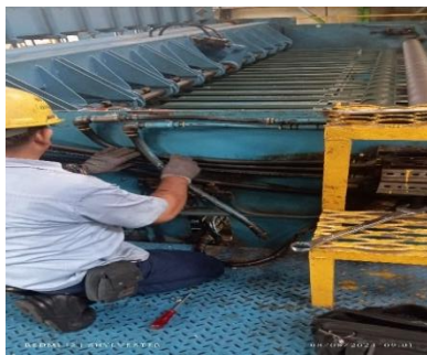
Gambar 2. 15 Gambar Ganti Hose pada SV dan Cylinder yang ada di Layboy (Sumber : Dokumentasi PT. Indah Kiat Pulp & Paper Perawang 2024.).
