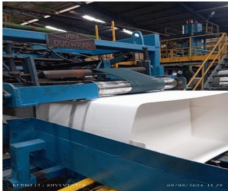
Gambar 3. 23 Gambar Wrapper yang sudah menempel pada Bale pulp tersebut (Sumber : Dokumentasi PT. Indah Kiat Pulp & Paper, perawang. 2024.).
