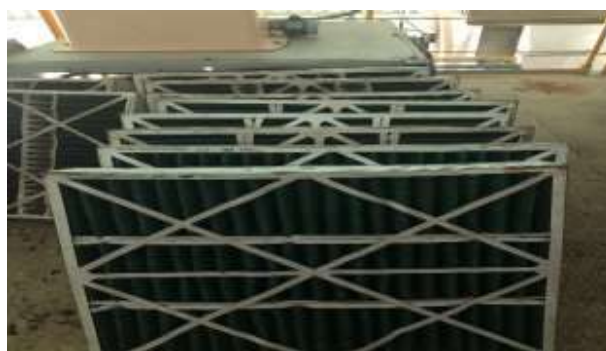
Pemasukan Saringan Turbin
