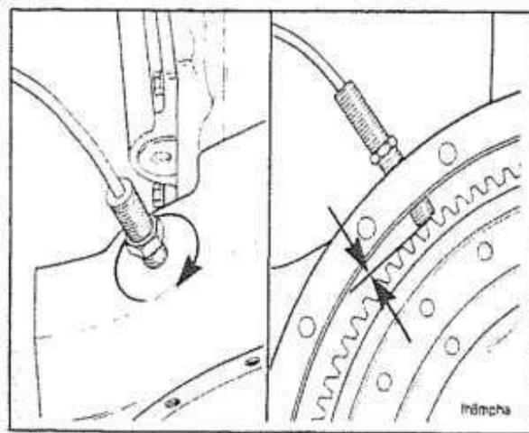
Kencangkan pickup magnetis sepenuhnya hingga menyentuh gigi roda gila. pickup akan dipasang dengan sangat mudah, jangan gunakan tekanan berlebihan untuk memasang pickup.
