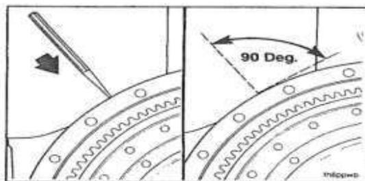
1. Lubang harus tegak lurus dengan gigi roda gigi. Lubangnya bisa berada dibagian mana pun dari roda gigi.
