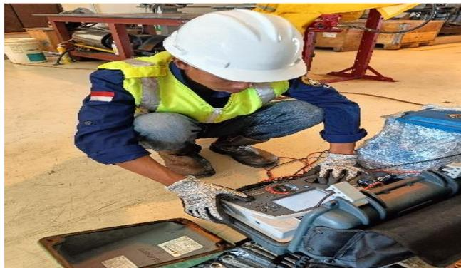
**Gambar 2. 15 Pengukuran Insulation Tester pada Motor**
