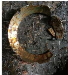
Gambar 4. 12 *Bearing* yang pecah
