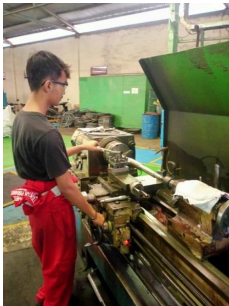
Gambar 4.9 Memastikan Pemakanan Sudah Mencapai yang di inginkan Sumber : Dokumentasi Penulis
