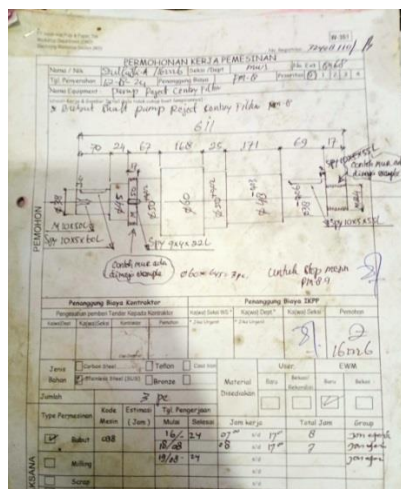
Gambar 4.5 Job Sheet Shaft Rejeck Sentry Filter PM-8 Sumber : Dokumentasi Penulis
