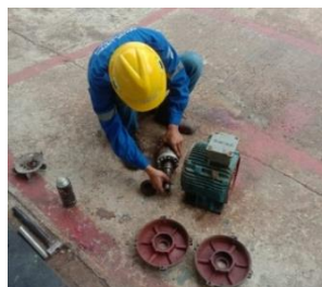
Gambar 2.14 Penggantian Bearing Motor (Sumber: Dokumentasi, 2024)
