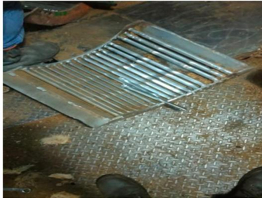
Gambar 4.24 Keausan *Rotor bar* Pada *Joint Plate*
