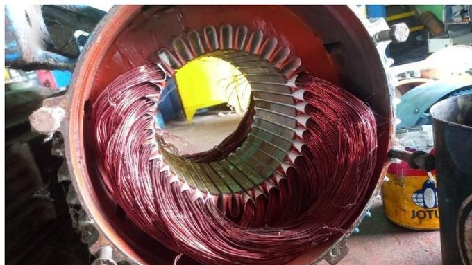
Gambar 3.4 Memasukkan Gulungan Pada Slot Stator.
