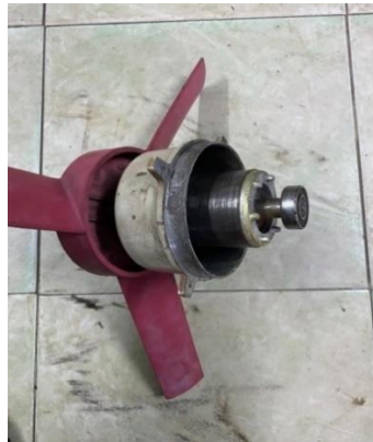
Bagian 3.5.1 rotor setelah di bongkar (Sumber: Unit Pertamina Sei Pakning 2024)
