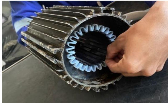
Gambar 3.5 .4 Pemasangan Mikanprespen Pada Stator (Sumber: Unit Pertamina Sei Pakning 2024)
