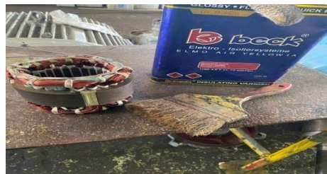
Gambar 3.5.14 proses penyirlak`an (Sumber: Unit Pertamina Sei Pakning)
