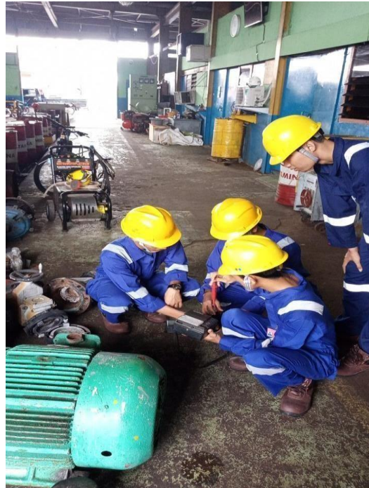
Proses Pengecekan Meger blower 1 phasa
