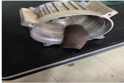
Gambar 3.5.2 Pengamplasan body dalam Stator (Sumber:Unit Pertamina Sei Pakning)
