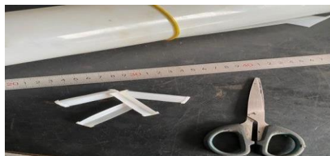
Gambar 3.5 .3 Proses Pembuatan Prispan Stator (Sumber:Unit Pertamina Sei Pakning)
