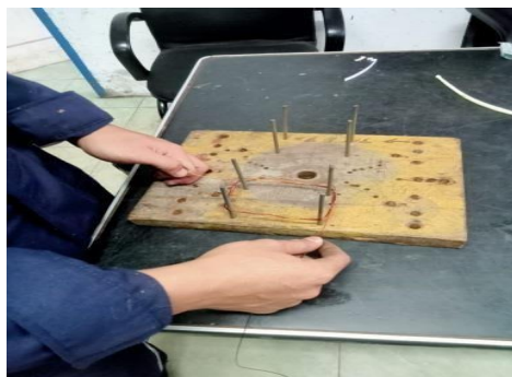
Gambar 3.5 .8 Proses Penggulung Kawat (Sumber:Unit Pertamina Sei Pakning)
