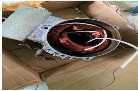
Gambar 3.5 12 Memasukkan Kawat Starting (Sumber:Unit Pertamina Sei Pakning)
