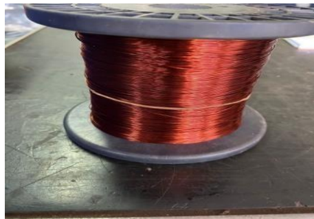
Gambar 3.5 10 Lilitan Kawat Ukuran Starting 0,43 Mm (Sumber: Unit Pertamina Sei Pakning)
