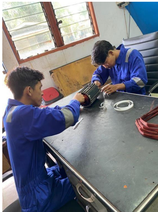
Proses pemasangan lilitan kawat di dalam tapal stator motor 1 phasa
