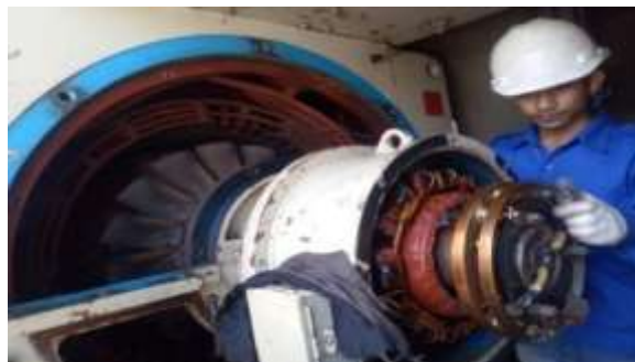
Gambar 3.1 7 Eksitasi tipe brushless Sumber : dokumentasi
