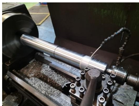
Gambar 4.18 Pembubutan Kasar (Raouging) Sumber : Dokumen Pribadi
