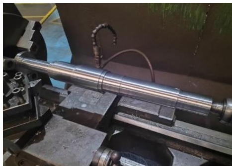
Gambar 4.20 Pembubutan Halus ( Finishing ) Sumber : Dokumen Pribadi
