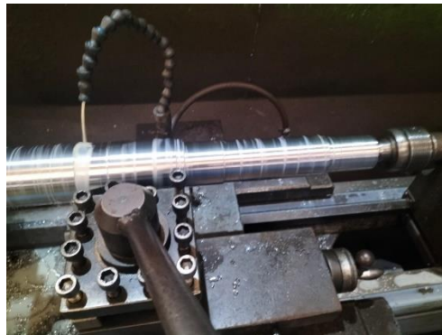
Gambar 4.19 Pembubutan Bertingkat Sumber : Dokumen Pribadi
