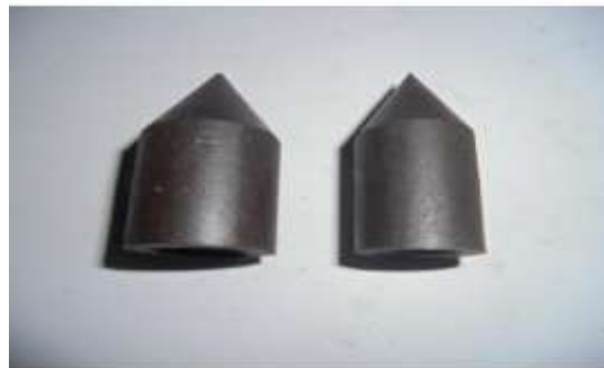
Gambar 3.4 Grounding Rod Drilling Head (Sumber:Dokumentasi Penulis,2024)
