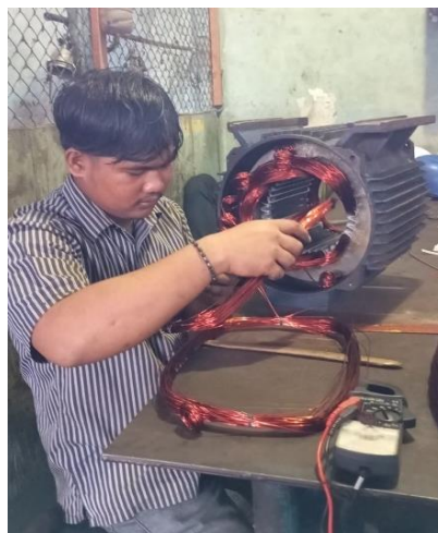
Gambar 2. 72 Memasang lilitan email drat pada stator Sumber: PTPN IV Sei Buatan
