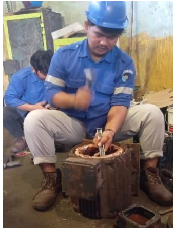
Gambar 2. 32 Membongkar lilitan email drat yang terbakar (Sumber: Dokumentasi di PTPN IV Sei Buatan,2024)
