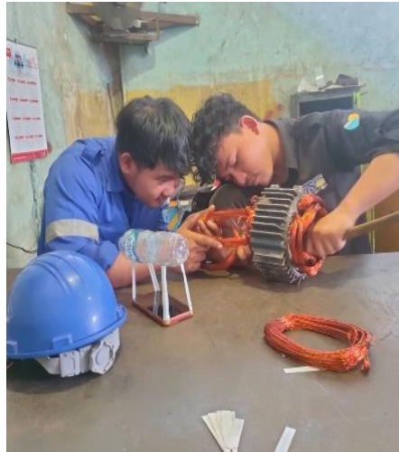
Gambar 2. 51 Pemasangan lilitan pada elmot pengutipan (Sumber: Dokumentasi di PTPN IV Sei Buatan, 2024)
