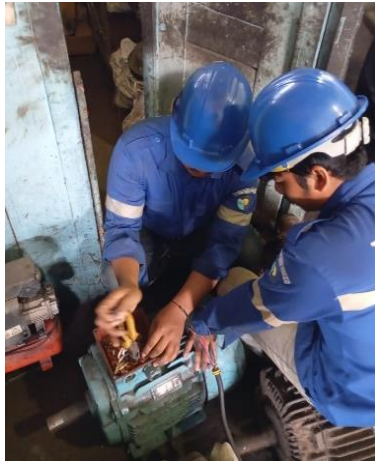
Gambar 2. 18 Mengetes/menguji elmot dengan rangkaian delta (Sumber: Dokumentasi di PTPN IV Sei Buatan,2024)
