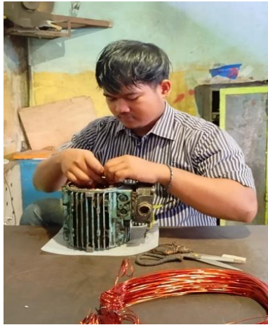
Gambar 2. 39 Menyeri lilitan pada elmot pengutipan (Sumber: Dokumentasi di PTPN IV Sei Buatan,2024)
