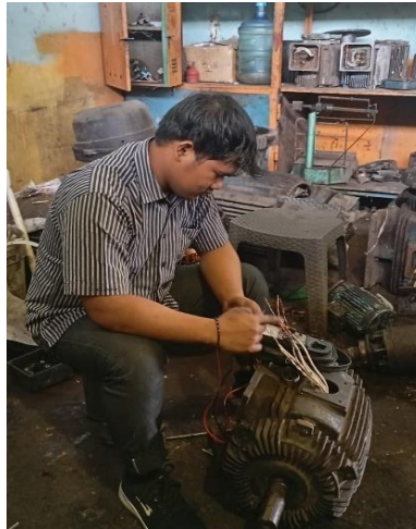
Gambar 2. 46 Mengcople/merakit elmot gester (Sumber: Dokumentasi di PTPN IV Sei Buatan, 2024)
