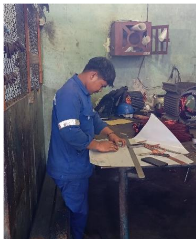
Gambar 2. 24 Membuat kertas gulungan dinamo/kertas nemox (Sumber: Dokumentasi di PTPN IV Sei Buatan,2024)
