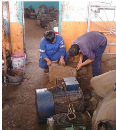
Gambar 2. 38 Membongkar elmot gester (Sumber: Dokumentasi di PTPN IV Sei Buatan,2024)
