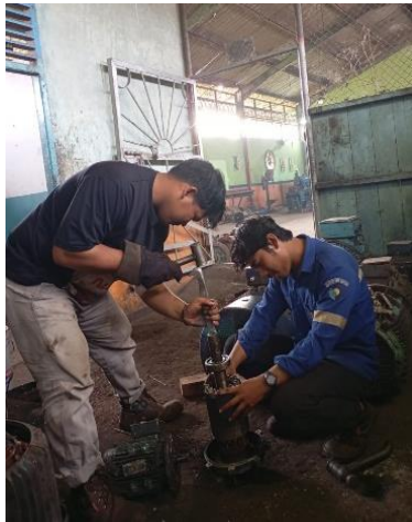
Gambar 2. 33 Memasang bering baru pada rotor elmot (Sumber: Dokumentasi di PTPN IV Sei Buatan,2024)
