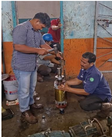
Gambar 2. 22 Mengantikan bering yang bagus pada rotor elmot (Sumber: Dokumentasi di PTPN IV Sei Buatan, 2024)
