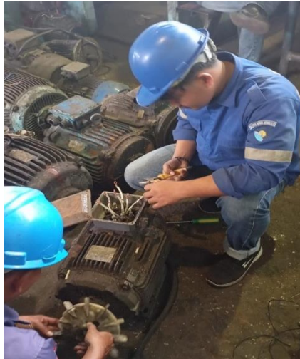
Gambar 2. 68 Menguji elmot reppil mill dengan Listrik 3 phasa (Sumber: Dokumentasi di PTPN IV Sei Buatan,2024)
