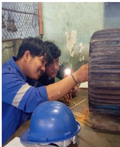
Gambar 2. 53 Membersihkan elmot dari kertas nomex yang tersisa (Sumber: Dokumentasi di PTPN IV Sei Buatan,2024)
