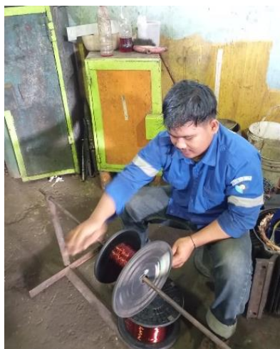
Gambar 2. 17 Menggulung email drat di bagi menjadi 2 tempat (Sumber: Dokumentasi di PTPN IV Sei Buatn,2024)
