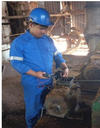
Gambar 2. 29 Memasang elmot ripple mill (Sumber: Dokumentasi di PTPN IV Sei Buatan, 2024)
