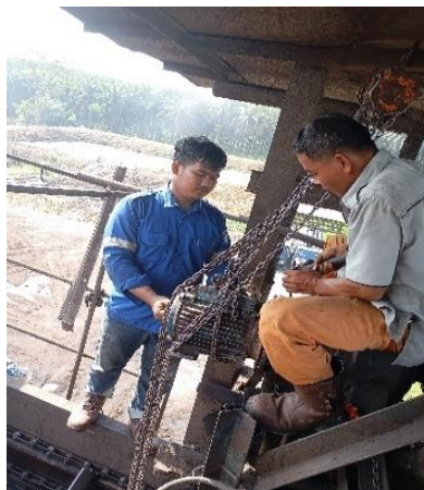
Gambar 2. 3 Mengantikan elmot EBC (conveyor) (Sumber: Dokumentasi di PTPN IV Sei Buatan,2024)
