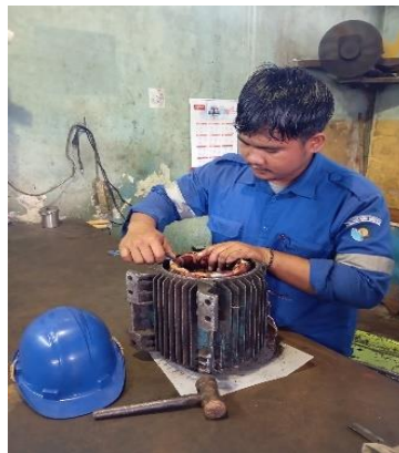
Gambar 2. 4 Membongkar lilitan email drat yang terbakar (Sumber: Dokumentasi di PTPN IV Sei Buatan, 2024)
