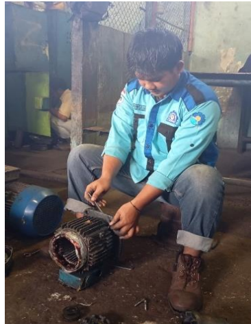
Gambar 2. 35 Membongkar elmot hoist crane (Sumber: Dokumentasi di PTPN IV Sei Buatan, 2024)
