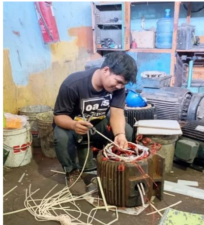
Gambar 2. 42 Mengikat lilitan email drat pada stator elmot gester Sumber: PTPN IV Sei Buatan
