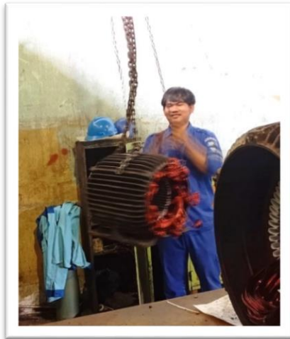
Gambar 2. 62 Menurunkan elomt dari meja (Sumber: Dokumentasi di PTPN IV Sei Buat, 2024)
