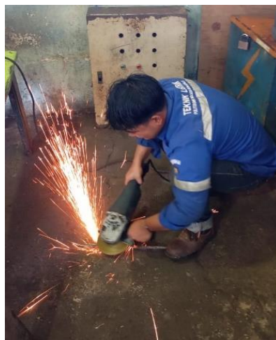
Gambar 2. 19 Menggrinda besi yang kasar supaya rapi dan alus (Sumber: Dokumentasi di PTPN IV Sei Buatan,2024)
