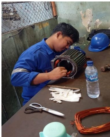
Gambar 2. 6 Belajar memasang lilitan email drat ke stator motor (Sumber: Dokumentasi di PTPN IV Sei Buatan, 2024)
