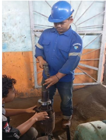
Gambar 2. 44 Memasang bering pada rotor (Sumber: Dokumentasi di PTPN IV Sei Buatan,2024)
