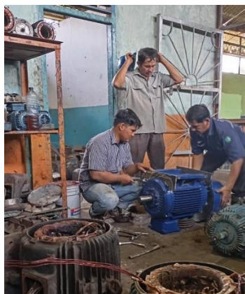
Gambar 2. 45 Mengcople/merakit elmot waduk (Sumber: Dokumentasi di PTPN IV Sei Buatan,2024)
