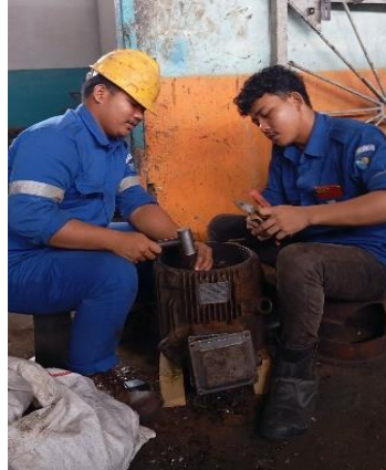
Gambar 2. 30 Membongkar lilitan email drat yang terbakar (Sumber: Dokumentasi di PTPN IV Sei Buatan,2024)
