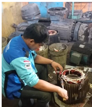
Gambar 2. 43 Menyolder lilitan email drat pada stator (Sumber: Dokumentasi di PTPN IV Sei Buatan, 2024)
