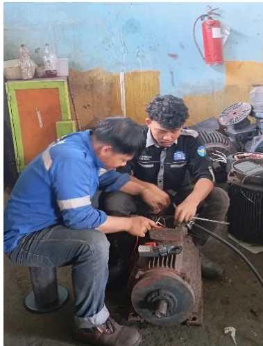
Gambar 2. 20 Mengukur phasa-phasanya dan U,V,W pada elmot (Sumber: Dokumentasi di PTPN IV Sei Buatan,2024)
