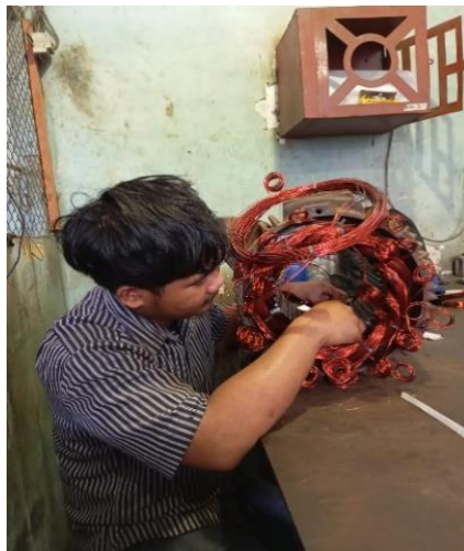
Gambar 2. 41 Memasang lilitan email drat pada stator (Sumber: Dokumentasi di PTPN IV Sei Buatan, 2024)
