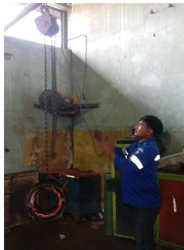
Gambar 2. 14 Menurunkan elmot dari meja (Sumber: Dokumentasi di PTPN IV Sei Buatan, 2024)
