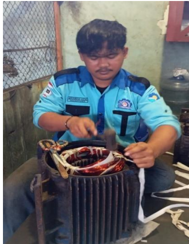
Gambar 2. 73 Mengikat lilitan yang sudah di masukkan ke stator (Sumber: Dokumentasi di PTPN IV Sei Buatan,2024)
