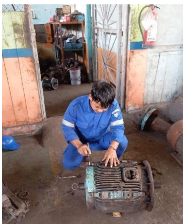
Gambar 2. 8 Membongkar elmot waduk dengan spesifikasi 45 KW (Sumber: Dokumentasi di PTPN IV Sei Buatan,2024)
