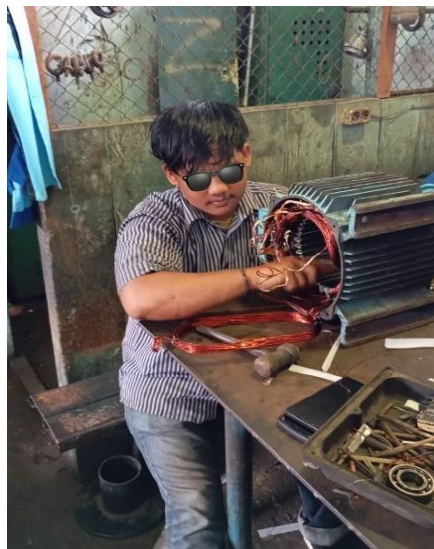
Gambar 2. 70 Memasang Lilitan email drat pada stator (Sumber: Dokumentasi di PTPN IV Sei Buatan, 2024)
