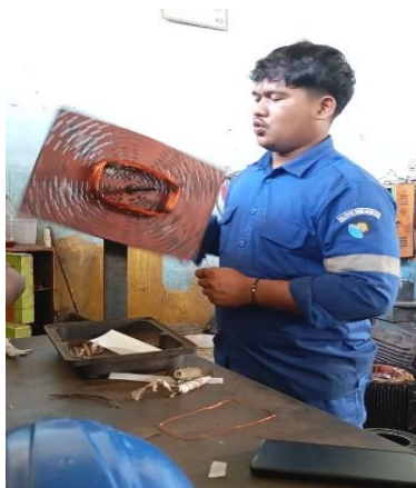
Gambar 2. 25 Menggulung email drat (Sumber: Dokumentasi di PTPN IV Sei Buatan, 2024)
