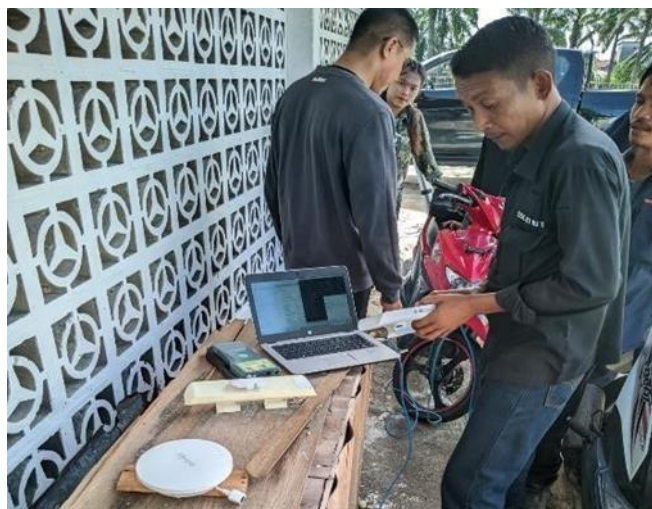
Gambar 3.5 Penggantian Radio Link (Nanostation)
