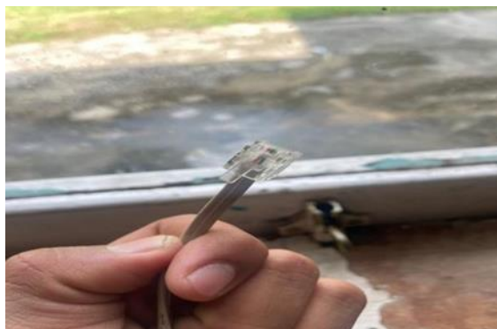
Gambar 4.24 Konektor RJ11 untuk Menghubungkan ke Perangkat Telepon
