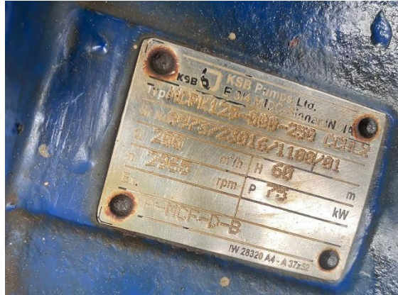
Gambar 4 6 Name Plat Pompa
