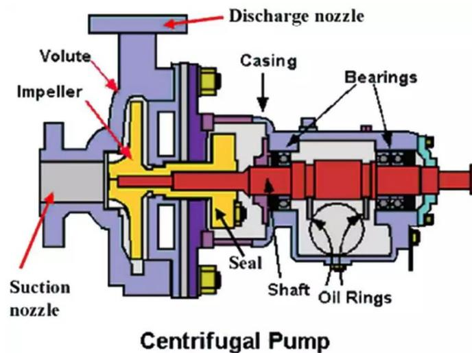
Gambar 4 1 Pompa Sentrifugal
