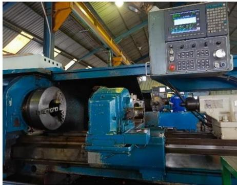
**Gambar 3. 5 Mesin bubut CNC**
