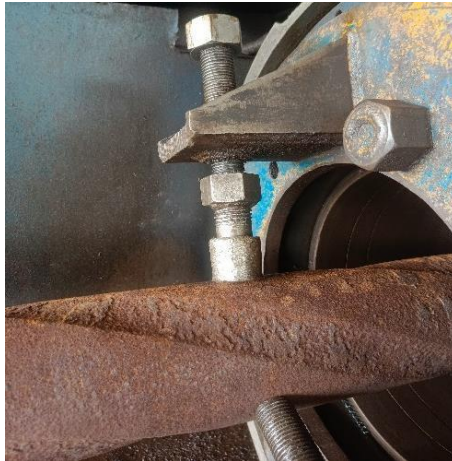
Gambar 4. 2 Pemasangan benda kerja pada cekam
