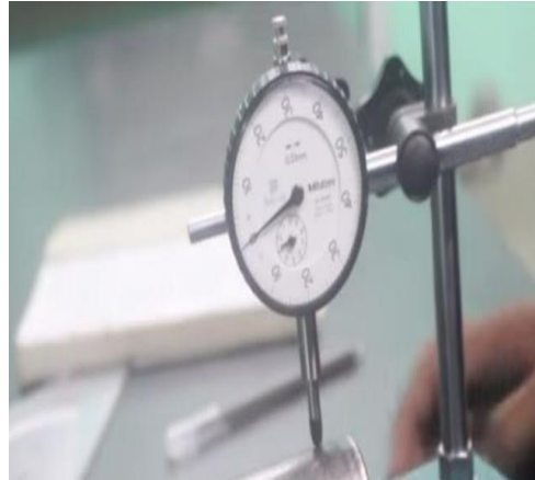
Gambar 4. 3 setting benda kerja menggunakan dial indicator
