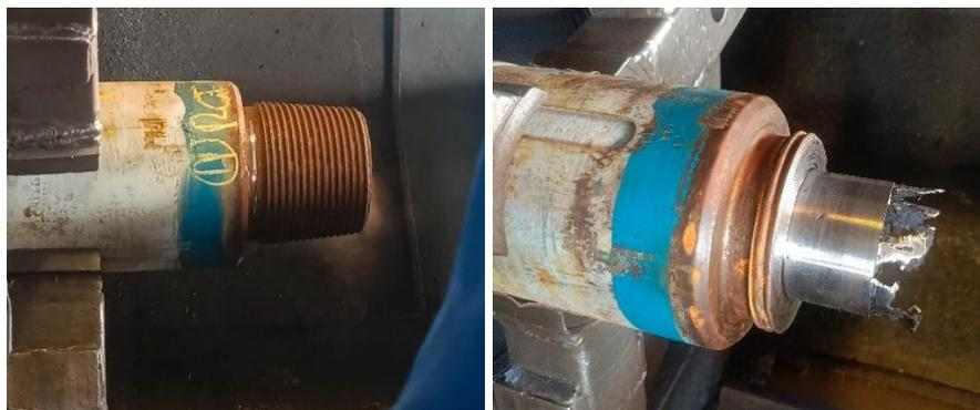
**Gambar 4. 4** proses pemotongan benda kerja
