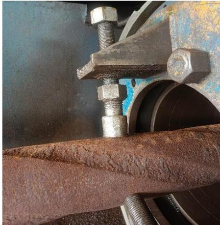
**Gambar 4. 2 Pemasangan benda kerja pada cekam**
