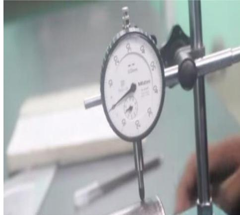
**Gambar 4. 3** setting benda kerja menggunakan *dial indicator*
