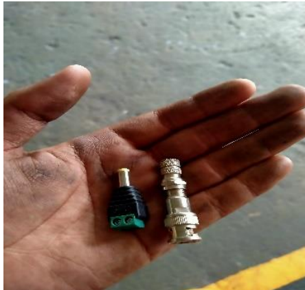
Gambar 3. 3 Pemasangan Adaptor dan BNC ( Sumber : Dokumen Pribadi )
