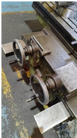
Gambar 4.3 Spindel penggerak sumbu X dan Y
