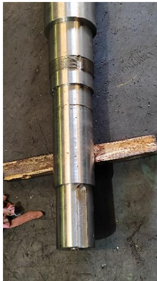
Gambar 4.19 lubang pasak yang telah selesai
