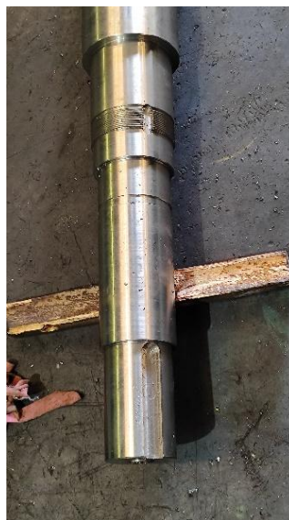
Gambar 4.19 lubang pasak yang telah selesai
