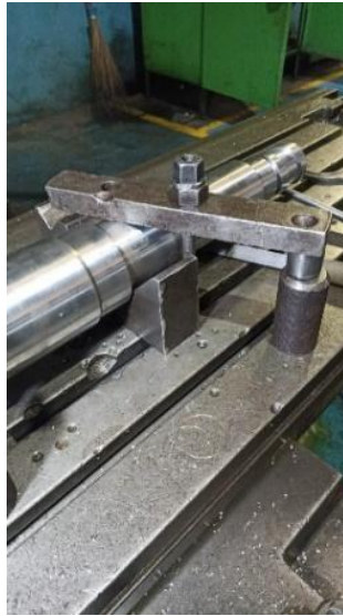
Gambar 4.14 ketika sudah terkunci benda kerja
