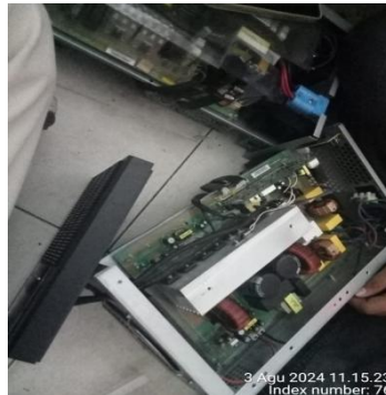
Gambar 3. 13 Ups yang telah dibongkar (Sumber Dokumen Pribadi)
