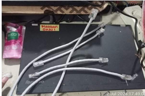
Gambar 3. 1 Kabel yang sudah dicrimping (Sumber Dokumen Pribadi)
