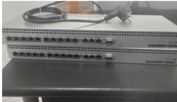
Gambar 3. 9 Mikrotik RB1100 4XAH (Sumber : Dokumentasi Penulis)
