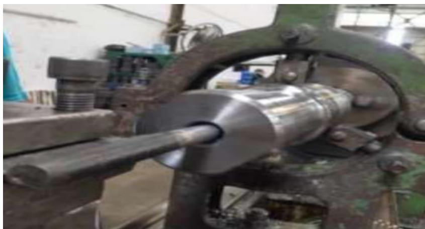
Gambar 4. 25 Pembuatan Lubang Ulir (Sumber:Dokumentasi)
