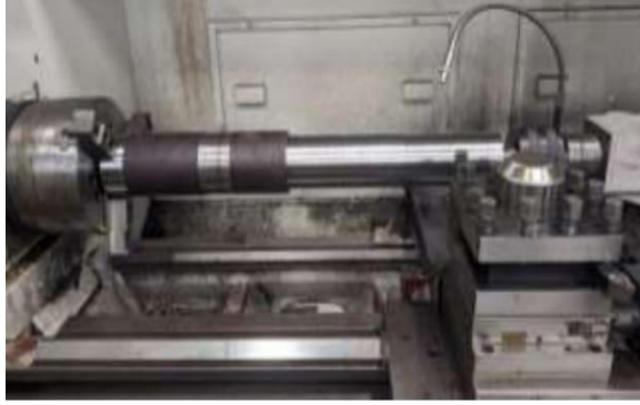
Gambar 4. 20 Proses pemakanan 50% (Sumber:Dokumentasi)
