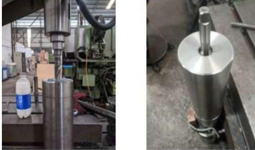
Gambar 4. 26 Proses Pembuatan Ulir (Sumber:Dokumentasi)
