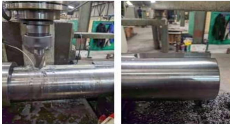
Gambar 4. 24 Proses Pembuatan Lubang SPI (Sumber:Dokumentasi)
