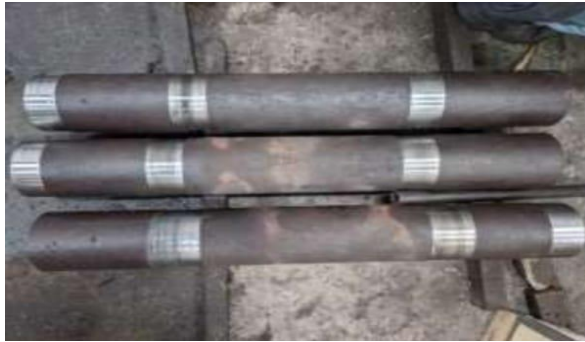
Gambar 4. 38 Benda Kerja Selesai Di center (Sumber:Dokumentasi)
