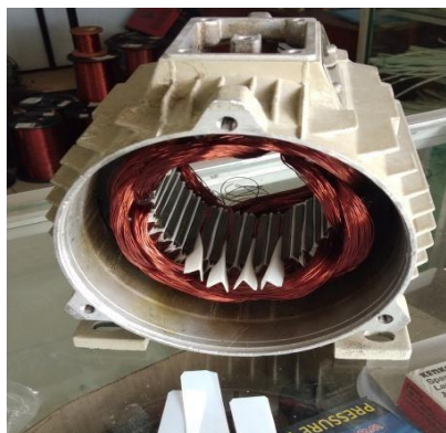
Gambar 3.10 Proses pemasangan penutup prespan. (Sumber : Unit Pertamina Sei Pakning 2024)
