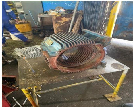
Gambar 3.3 stator motor finfan 3 phasa (Sumber : Unit Pertamina Sei Pakning 2024)
