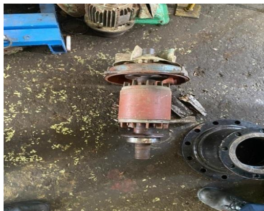
Gambar 3.4 Rotor pada motor finfan 3 phasa (Sumber : Unit Pertamina Sei Pakning 2024)
