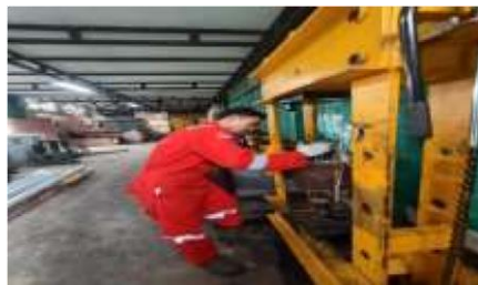
Gambar 2. 11 Mengganti Bering Motor
