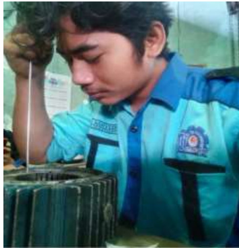
Gambar 2. 35 membersihkan slot rotor (sumber: PTPN IV Regional III)
