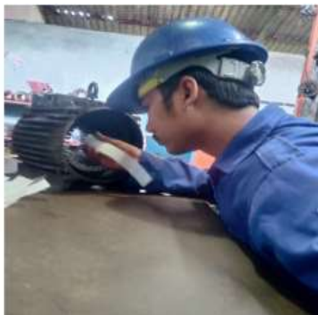
Gambar 2.4 memasang litroid kedalam slot rotor (Sumber: PTPN IV regioal III)
