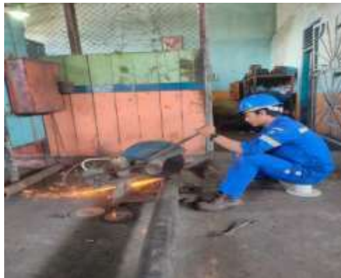
Gambar 2.16 membuat elbow (sumber: PTPN IV Regional III)
