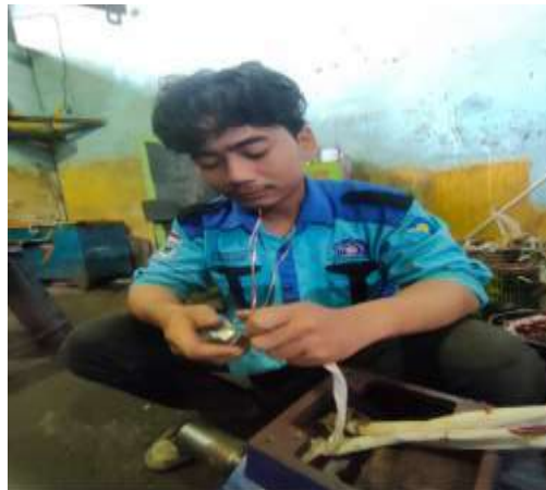
Gambar 2. 54 mengikis lapisan pada kawat (sumber: PTPN IV Regional III)
