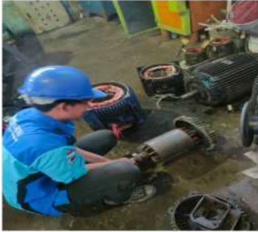
Gambar 2. 55 mengikis lapisan pada kawat (sumber: PTPN IV Regional III)
