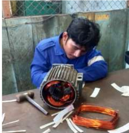
Gambar 2. 31 memasang liitan (sumber: PTPN IV Regional III)
