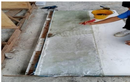
Gambar 4.15 Proses laminasi pembuatan plat
