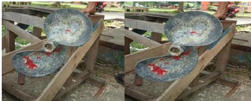
Gambar diatas adalah gambar proses balancir yang dilakukan sesudah melakukan pengujian.
