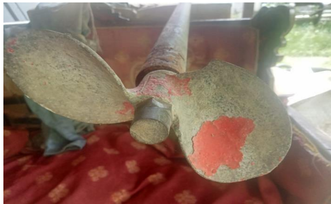
Gambar 2.1 kavitasi propeller (Sumber: Dokumentasi lapangan, 2024)
