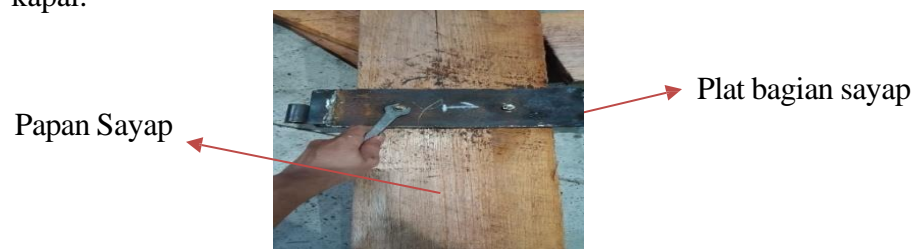
Gambar 4.23 Pemasangan Papan Pada Alat Sumber : Dokumentasi 2024
