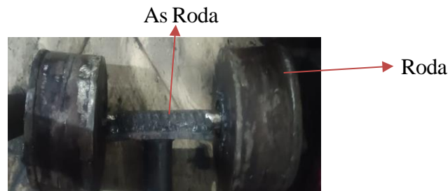
Gambar 4.12 As Roda Telah Terpasang Pada Roda Sumber: Dokumentasi 2024
