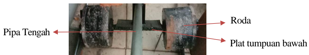
Gambar 4.17 Penyatuan Plat Tumpuan Dengan As Roda Sumber : Dokumentasi 2024
