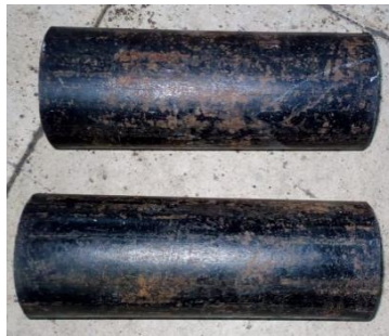
Gambar 4.16 Pipa Sebagai Bantalan/Penumpu Beban Sumber : Dokumentasi 2024
