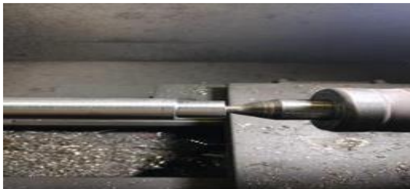
Gambar 4.6 Pembubutan Bertingkat Sumber: Dokumentasi Penulis, 2024
