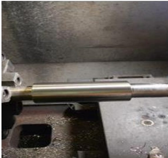
Gambar 4.9 Pembubutan Bertingkat Sumber: Dokumentasi Penulis, 2024
